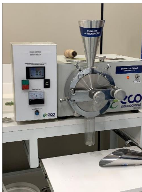
Figura 3 - Moinho de facas tipo Willey, utilizado para o processamento do sabugo do milho
