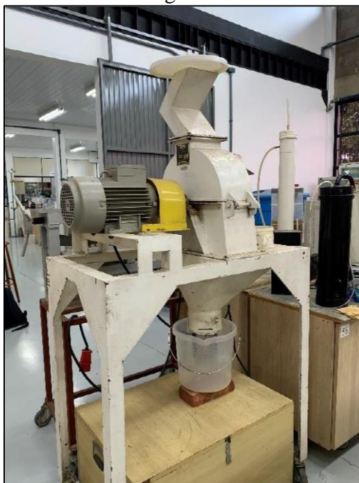
Figura 2 - Moinho de facas industrial, utilizado para o processamento do sabugo do milho
