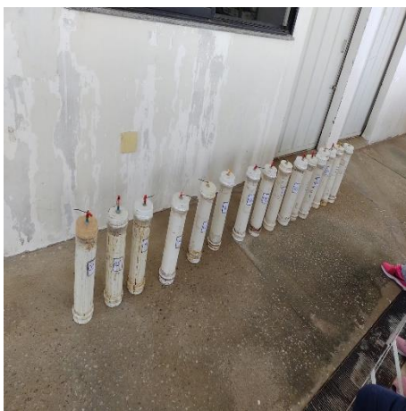
Figura 2: Mini Silos de palma forrageira e resíduo de acerola
