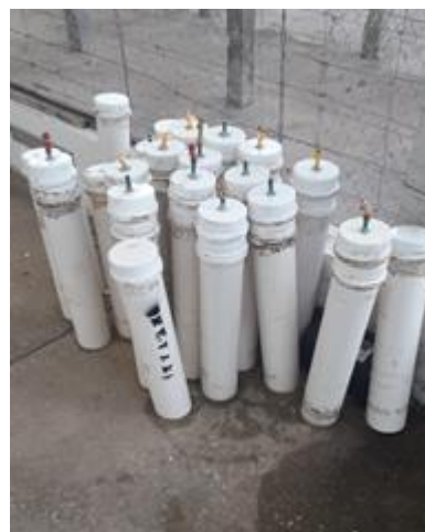
Figura 2: Mini Silos de palma forrageira e resíduo de acerola
