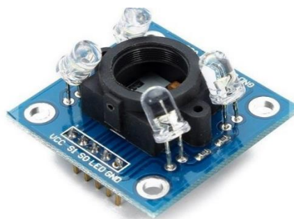
Figura 4 – Sensor TCS230 onde pode-se ver os 4 LEDs brancos que iluminam o objeto e o fotodiodo detector no interior do invólucro de proteção. Fonte: ElectroFun blog (2021)
