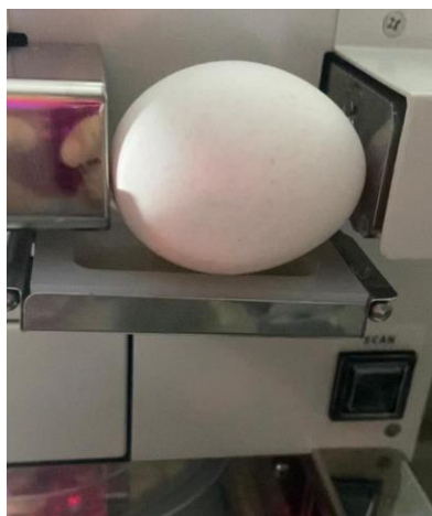
Figura 5 – Posição correta do ovo de galinha in natura no Compressor de baixa velocidade do Digital Egg Tester DET6500. Fonte: Vinhas RV, 2023.
