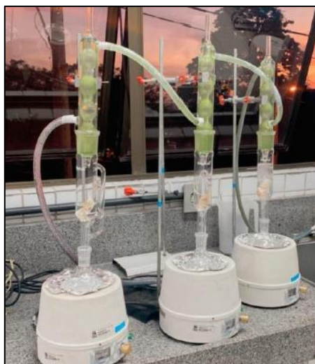
Figura 1. Extração de gordura da salsicha, no Soxhlet na presença de hexano
