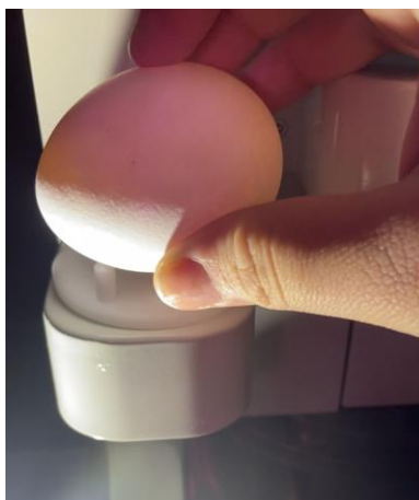
Figura 4 – Posição correta do ovo de galinha in natura na balança do Digital Egg Tester DET6500. Fonte: Vinhas RV, 2023.
