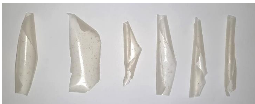
Figura 3. Filmes elaborados com amido de milho e 5% de FP.
