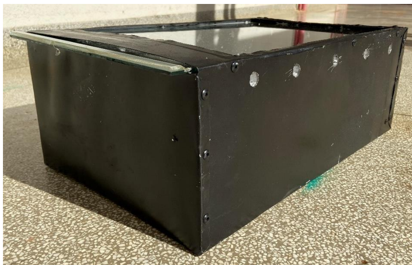
Figura 1 – Secador solar confeccionado de chapa de zinco e utilizado nas secagens das fatias de mamão desidratadas osmoticamente com diferentes agentes hipertônicos
