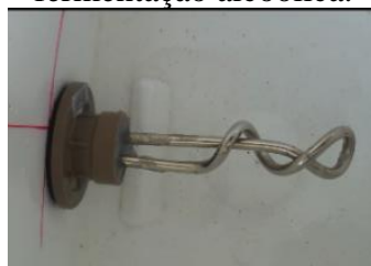
Fonte de aquecimento
