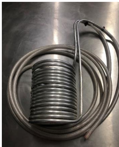
Figura 4 – chiller de imersão
