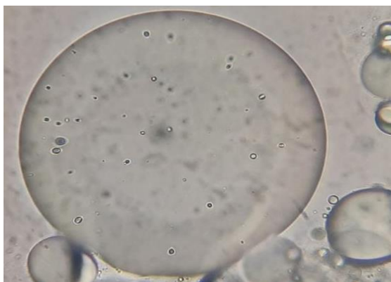
Figura 1 A: Microcápsulas no microscópio óptico normal com ampliação de 400x.
