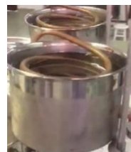
Condensador com serpentina de cobre
