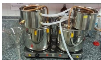
Alambique de inox e serpentina de cobre
