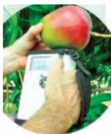
Figura 5 - Uso do infravermelho próximo (NIR) portátil em mangas [7].
